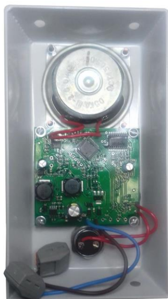
Рисунок 4 – Вид на разъемы УЭС-ПВ (основание снято)
